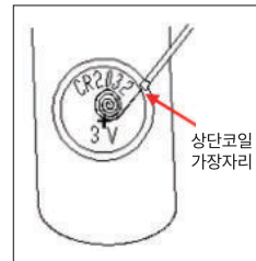
수명이 다한 배터리는 일자 드 라이버를 사용하여 상단 코일 의 가장자리 부분을 살짝 누르 시면 배터리가 분리됩니다.
